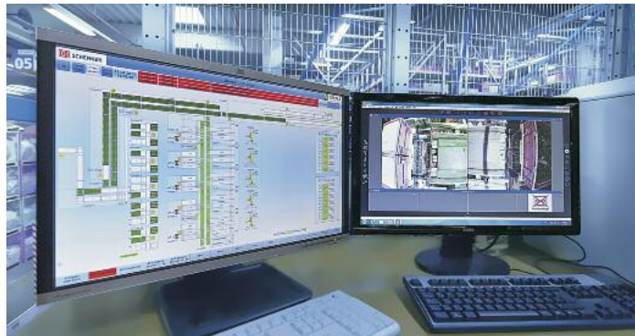
Das Visualisierungsmodul PMS-V schafft Transparenz bei den Materialflüssen und in Bezug auf die Anlagenauslastung
