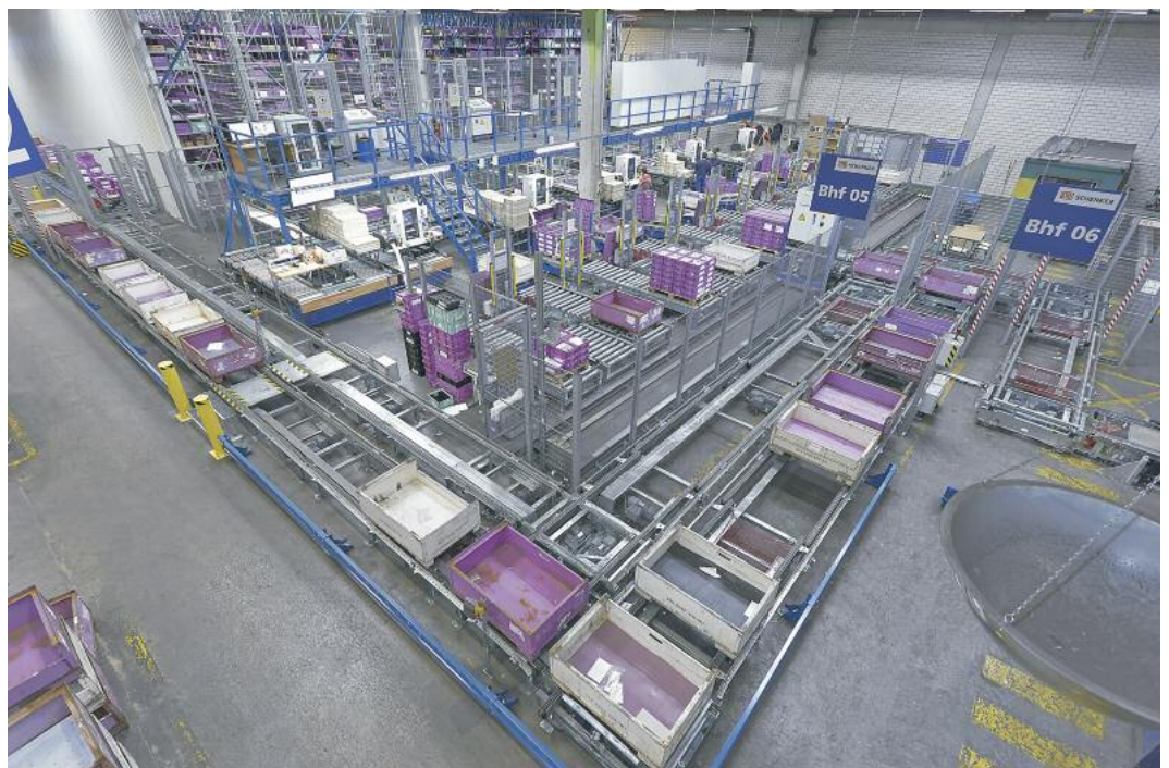
In der Vorzone sind die Arbeitsplätze gut zugänglich angeordnet. Eine 50 m lange Palettenförderstrecke dient als Staustrecke für die Wareneingangspalette und leeren Transportboxen
