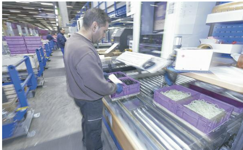
An fünf Arbeitsstationen werden Kleinladungsträger (KLTs) von Tablaren in Transportboxen kommissioniert. Beim Einlagern werden die in Großladungsträgern ankommenden KLTs vereinzelt und mit den Tablaren verknüpft
